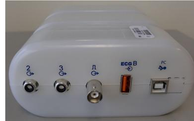
Auf der Rückseite des Moduls befinden sich zwei nicht-funktionale Analogausgang-Steckverbinder (2 und 3) und ein TTL-Ausgangsteckverbinder (TTL).
