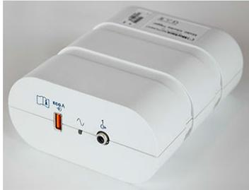
Das XScribe AM12 Patientenkabel muss an den EKG-A USB-Steckverbinder an der Vorderseite des Triggermoduls angeschlossen werden. Ein aktiver Analogausgang-Steckverbinder (1) befindet sich ebenfalls auf der Vorderseite.
