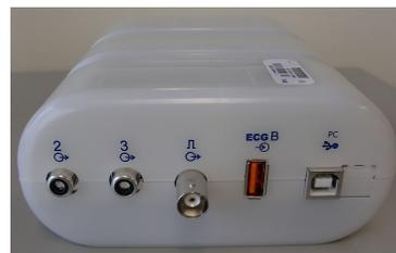
Auf der Rückseite des Moduls befinden sich zwei analoge Ausgangsanschlüsse (2 und 3 sind derzeit nicht funktionsfähig) und ein TTL-(TTL) Ausgangsanschluss.
