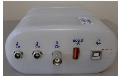
L'arrière du module comprend deux connexions de sortie analogique non fonctionnelles ( $\odot 2$  et  $\odot 3$ ) et une connexion de sortie TTL ( $\square \odot$ ).
