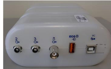
L'arrière du module fournit deux connexions de sortie analogique (2 et 3 ne sont actuellement pas fonctionnels) et une connexion de sortie TTL (TTL).
