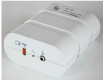
Le câble patient XScribe AM12 doit être connecté à un connecteur USB ECG A situé à l'avant du module de déclenchement. Une connexion de sortie analogique active ( $\odot 1$ ) se trouve également à l'avant.
