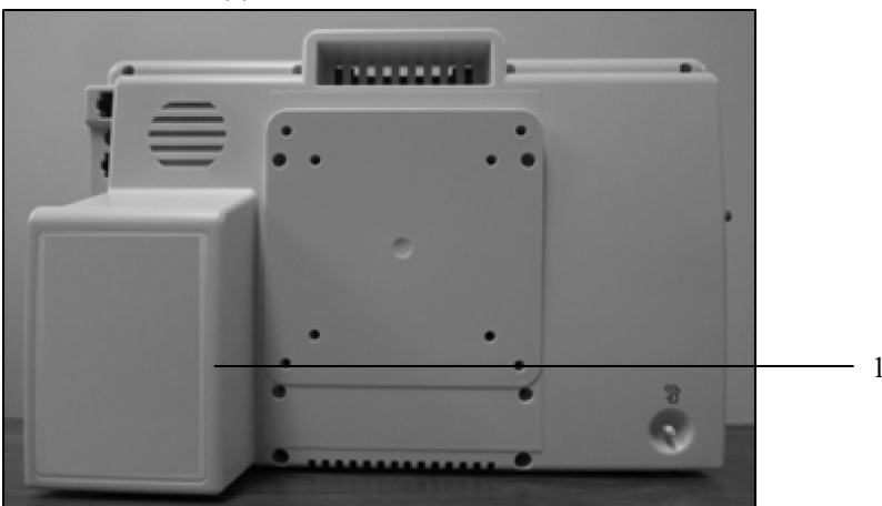
7. ábra – Surveyor betegmonitor: Az opcionális betegágy melletti regisztrálókészülékkel felszerelt S12 hátulnézetből (1)
