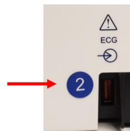
La etiqueta circular con el número 2 en la parte posterior de la carcasa del electrocardiógrafo ELI situada junto al conector de entrada de ECG indica que el electrocardiógrafo contiene una UTK versión 2 en el interior.
