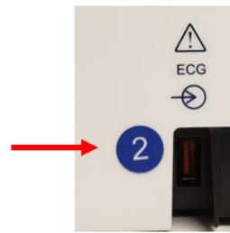
Uma etiqueta circular número 2 na parte de trás do eletrocardiógrafo ELI, localizada ao lado do conector de entrada de ECG, indica que o eletrocardiógrafo contém, internamente, um UTK versão 2.
