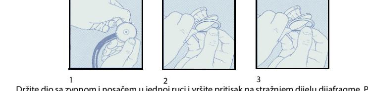
Držite dio s zvonom i nosačem u jednoj ruci i vrste pritisk na stražnjem dijelu dijaphragme. Primate prsten dijaphragme s novojem drugom rukom i okrenite ga na smjer obrnutom od kazaljke na satu kako bi ga otpustili.
