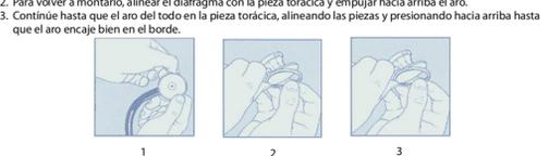
El aro antienfrente de la campana puede quitarse y volverse a poner de la misma forma. Inspeccione de forma rutinaria el fonendoscopio en busca de signos de desgaste y deterioro. No lo utilice si detecta signos de deterioro, si el instrumento no funciona correctamente o si observa un cambio en el rendimiento. Póngase en contacto con el servicio de asistencia técnica de Hill-Rom para obtener ayuda.
