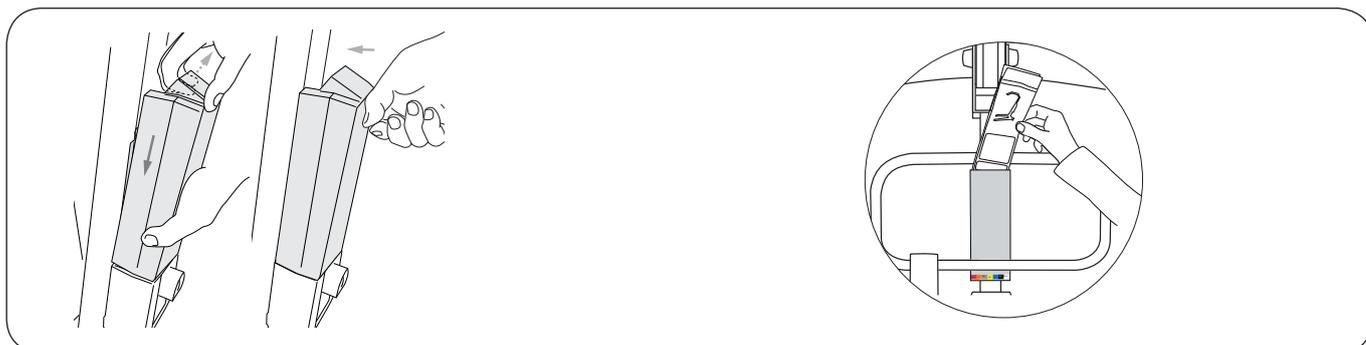
5. Connectez la batterie et fixez-la à la raquette du boîtier de contrôle. Un déclic se fait entendre lorsque la batterie est correctement installée.
