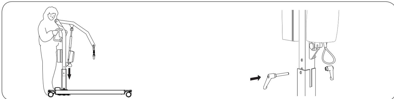
1. Bloquez les deux roues arrière. Enlevez les poignées de verrouillage du piètement et encastrez le pied central dans le piètement.
