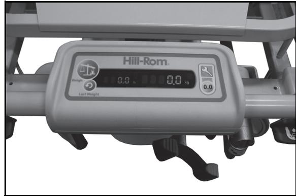
Die Genauigkeit des Wiegesystems beträgt 1 % bzw. 1 kg (höherer Wert ist ausschlaggebend) und der Betriebsbereich des Wiegesystems liegt zwischen 0 kg und 317,5 kg. Das Bedienelement für das Wiegesystem befindet sich am Fußende der Liege.
