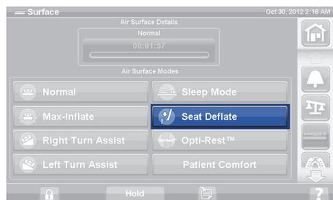
La superficie per terapia **Progressa** esce automaticamente dalla modalità di sgonfiaggio della seduta e ritorna alla modalità normale dopo 30 minuti. Dopo 28 minuti, un segnale acustico e un messaggio sull'interfaccia GCI indicheranno che sono rimasti 2 minuti.
