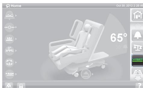
2. Premere **Right Turn Assist** (Rotazione assistita a destra) o **Left Turn Assist (Rotazione assistita a sinistra)**. Il pulsante diventa **verde** quando è attivo.
