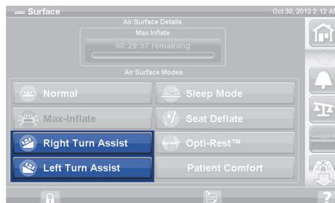
Dopo 28 minuti, un singolo segnale acustico e un messaggio segnalano che mancano due minuti. L'operatore può scegliere di mantenere la modalità Turn Assist (Rotazione assistita) o lasciare che torni alla modalità normale.
