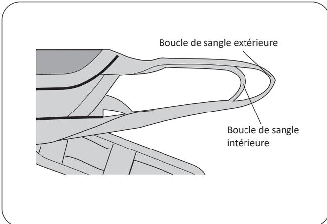
La sangle extérieure est dotée de deux boucles : une boucle extérieure et une boucle intérieure pour un maximum de flexibilité lors de l'utilisation. En général, il est recommandé d'utiliser la boucle intérieure afin d'obtenir une position aussi verticale que possible et de permettre au patient d'atteindre l'étrier pour pouvoir participer à la verticalisation.
