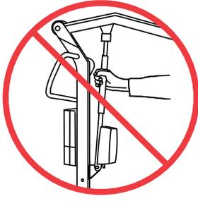
**⚠ Ne déplacez jamais l'appareil en tirant sur l'actionneur !**
