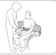
3. Tirare le cinghie con occhielli per verificare che la cintura si stringa. Se la cintura addominale non si stringe a sufficienza, cambiare la disposizione delle cinghie con occhielli.
