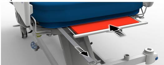
10. Ajuste la hebilla de posicionamiento del portaplacas. Enrolle la correa correcta alrededor del colchón y coloque la hebilla en el borde superior del colchón. Una vez que se ha ajustado usando las correas derecha e izquierda, esta hebilla se usa para colocar la parte superior del portaplacas según sea necesario.
