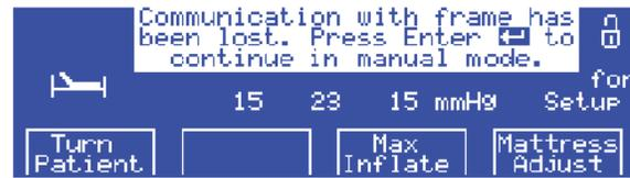
Wenn das System die drei oben aufgelisteten Bedingungen erfüllt und die elektrische Verbreiterung immer noch nicht funktioniert, kann bei der Luftzufuhreinheit ein interner Fehler der Kommunikationsbaugruppe vorliegen. In diesem Fall wird die Meldung **Communication Error** (Kommunikationsfehler) angezeigt.
