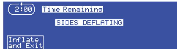
2. Wenn die Seitenpolster 30 Minuten lang luftleer bleiben, ist ein Alarmton zu hören. Drücken Sie auf **Audio Pause** (Audio-Pause), um den Alarm für 10 Minuten stummzuschalten.
