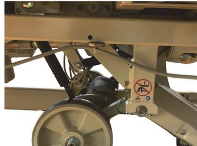
14. Führen Sie den sechsten und siebten Magneten mit einer Serviceschleife am mittleren Rahmen entlang, und bringen Sie sie an der linken Ecke des Kopfendes am Rahmen an.
