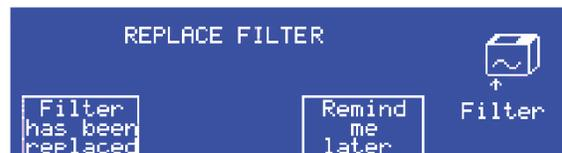
drücken Sie auf **Remind me later** (Später erinnern). Wenn die Luftzufuhrreinheit wieder eingeschaltet wird, wird der Bildschirm **Replace Filter** (Filter ersetzen) angezeigt.
