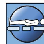
**Aktivierung** – Drücken und halten Sie die Bedientaste **Bett flachstellen**, bis das System ganz flach ist. Wenn alle Bereiche flach sind und das Bett sich in der Horizontalen befindet, bricht das System ab und ein Piepton ertönt.
