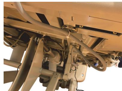
11. Bringen Sie den dritten Magneten mit einer Serviceschleife entlang der Seite des mittleren Rahmens an der aus Patientensicht linken Bettseite an.
