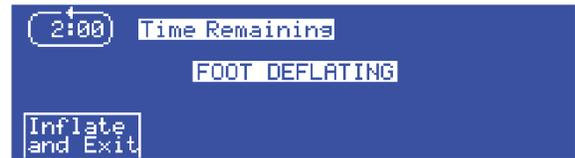
Drücken Sie vor dem Abschluss **Inflate** (Befüllen) und **Exit** (Beenden), um das Ablassen von Luft aus dem Fußteil (**Foot Deflate**) abzubrechen. Das Fußteil wird mit Luft befüllt, der Bildschirm **Foot Inflating** (Fußteil wird befüllt) blinkt fünf Sekunden lang, und anschließend wird der Bildschirm „Pressure Redistribution“ (Druckumverteilung) angezeigt.
