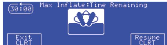
10. Wenn **Exit CLRT** (CLRT beenden) ausgewählt wurde, wird der Patient in der Mitte der Auflage gelagert, die CLRT beendet und die Auflage in den Modus „Pressure Redistribution“ (Druckumverteilung) zurückversetzt. Der Bildschirm „Pressure Redistribution“ (Druckumverteilung) wird angezeigt.
