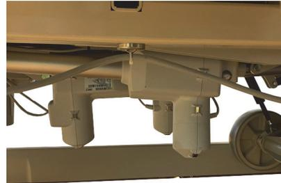
13. Führen Sie den fünften Magneten mit einer Serviceschleife am mittleren Rahmen entlang, und bringen Sie ihn an der Seite des Antriebs am Rahmen an.
