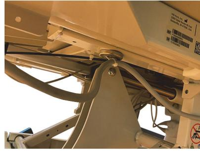
12. Führen Sie den vierten Magneten mit einer Serviceschleife am mittleren Rahmen entlang, und bringen Sie ihn an der Seite des Antriebs der Höhenverstellung am Rahmen an.
