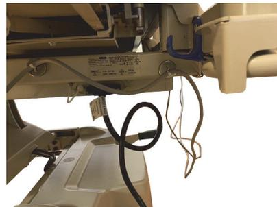
15. Schließen Sie das Netzkabel der Luftzufuhreinheit an die Wechselstromquelle an. Positionieren Sie die Luftzufuhreinheit so, dass das Netzkabel problemlos herausgezogen werden kann.
