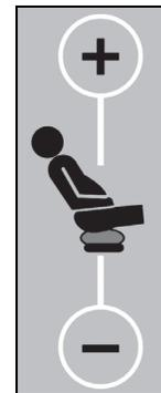
Um das **Sitzteil automatisch aufzublasen oder zu entleeren**, halten Sie die Funktionstaste **Sitzteil aufblasen** (Plus-Zeichen) bzw. **Sitzteil entleeren** (am Bedienelement für Pflegepersonal; Minus-Zeichen) gedrückt.
