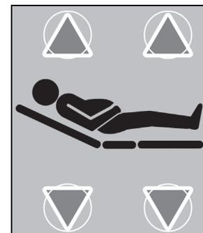
**Höherstellen** – Halten Sie die Funktionstaste **Fußteil Auf** gedrückt, um das Fußteil höher zu stellen.
